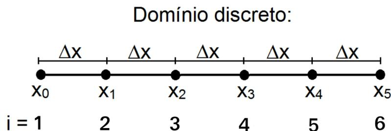
Neste caso, a discretização da EDP na direção  $x$  irá resultar um conjunto de valores  $(T_1, T_2, T_3, T_4, T_5, T_6)$  que representam a temperatura nos pontos respectivos  $(x_1, x_2, x_3, x_4, x_5, x_6)$ .
