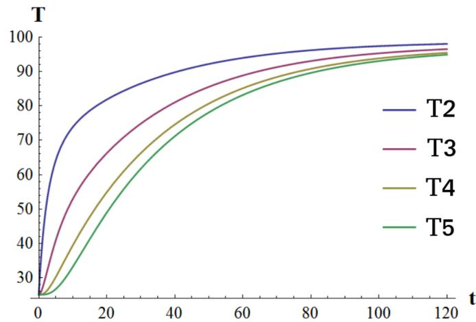
Pode-se observar que para altos valores de tempo as temperaturas tendem a um valor específico, ou seja, tendem para um valor estacionário. Estes valores correspondem exatamente aos obtidos para a resolução do caso onde o comportamento transiente é desprezado.
